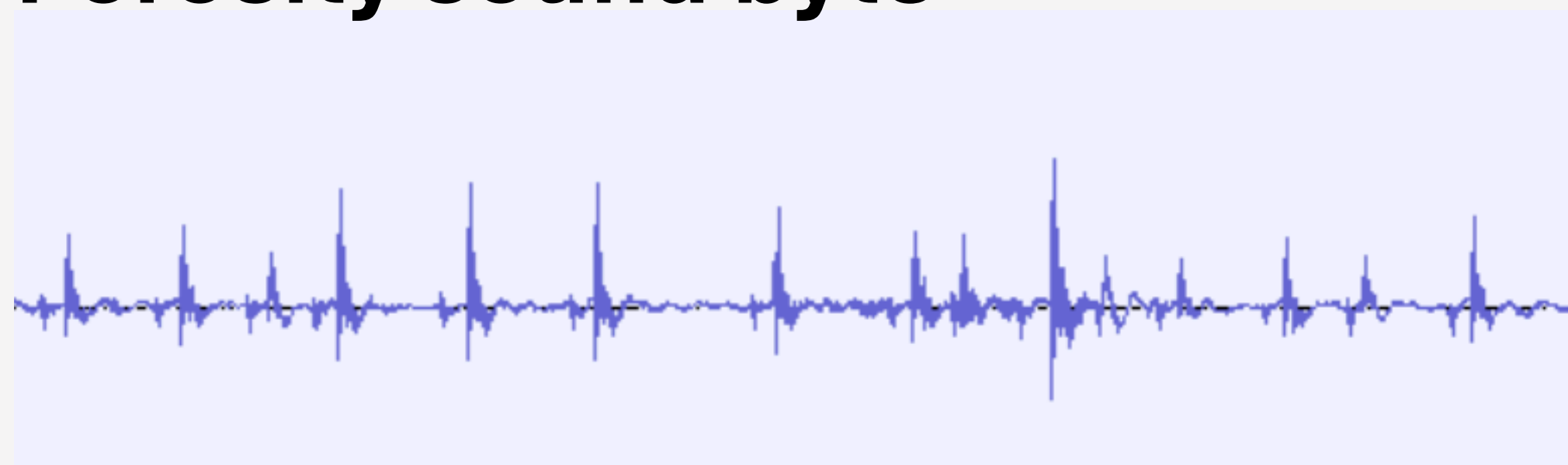
Good weld sound byte
